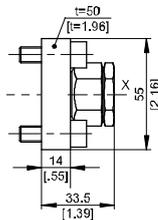
Hubabhängiger Dämpfungsdeckel Typ "D"
