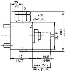
Hydraulischer Druckminderventildeckel Typ "R"
